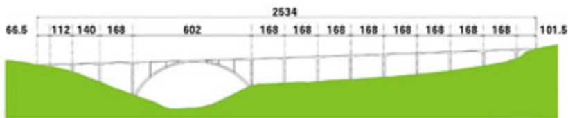
Viaduc en arc central
