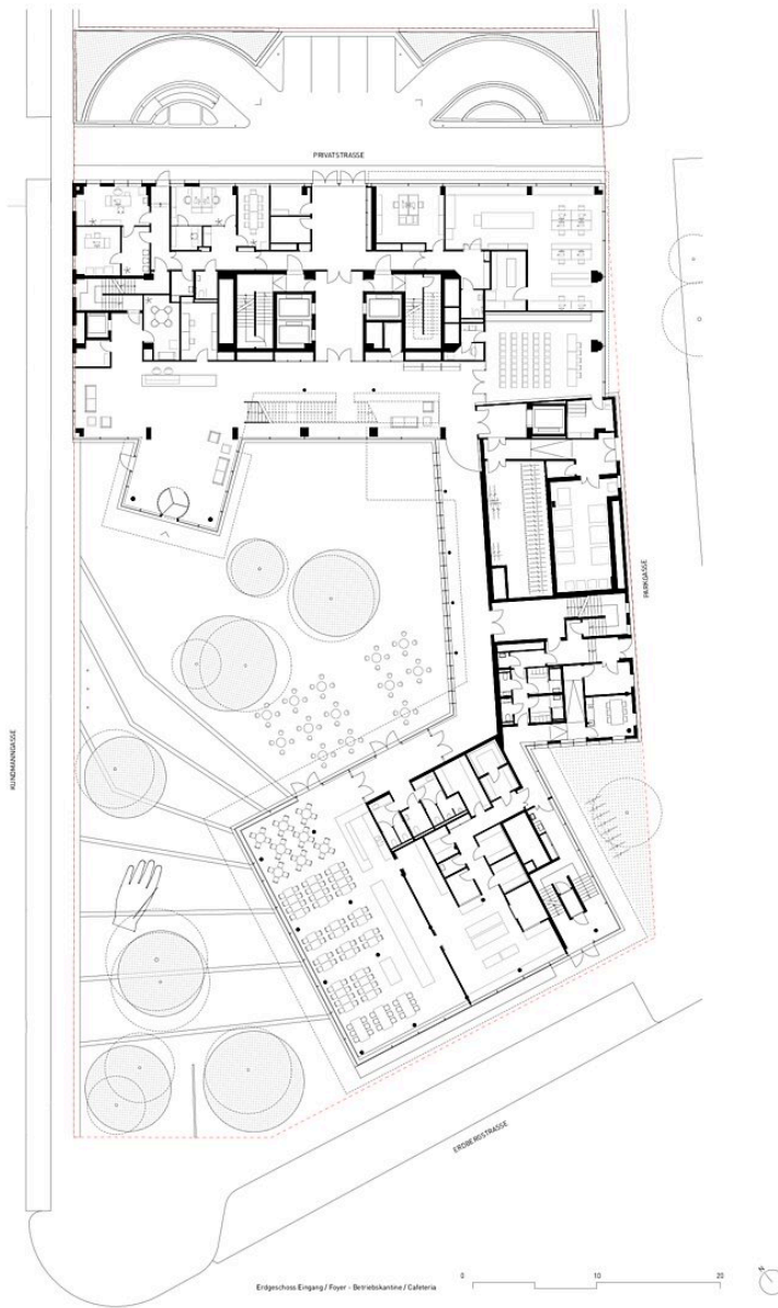
Grundriss EG Eingang Foyer Betriebskantine Cafeteria
